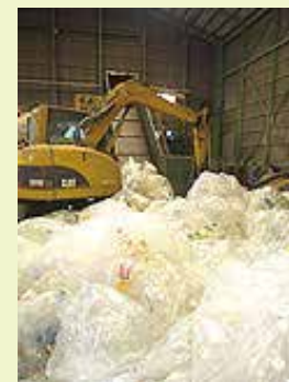
嵩の大きいペットボトルは、圧縮・破碎をかけて減容します。
